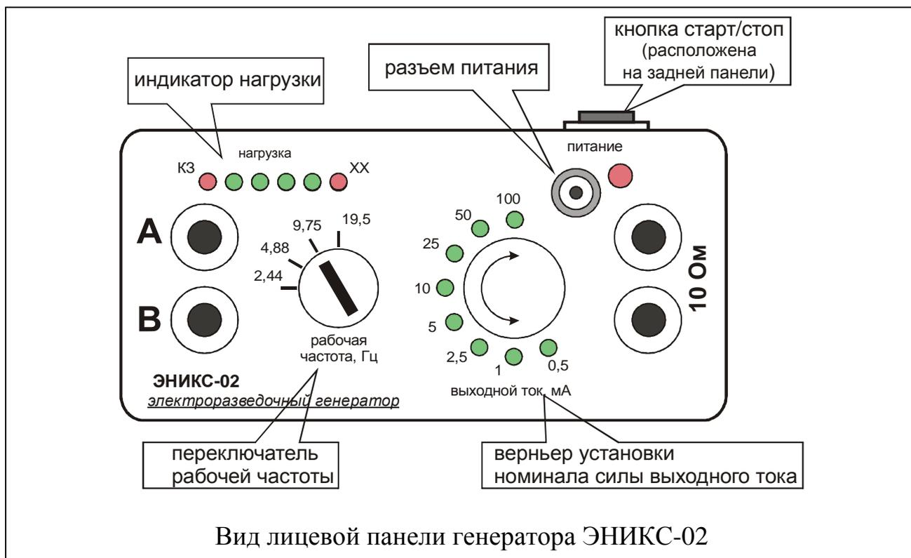
Звуковая индикация параметров работы включается только при генерации выходного тока в режимах перегрузки - ограничения выходного напряжения «сверху» (более 233 В) или «снизу» (менее 33 В).
