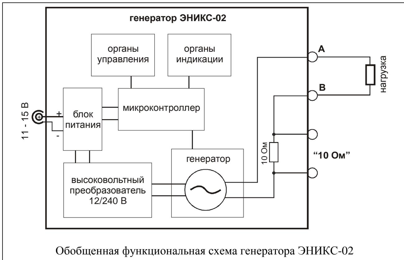
Контрольный токосъемный резистор предназначен для измерения выходного тока генератора с помощью электроразвездочного измерителя (вольтметра).
