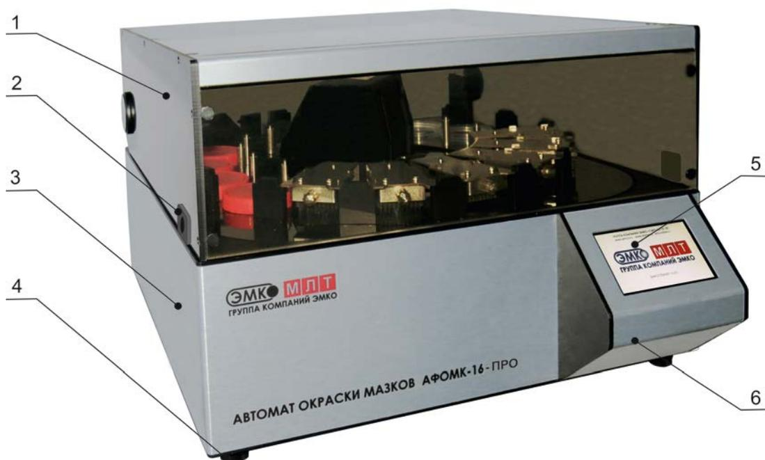
Рис 1. Внешний вид автомата АФОМК-16-ПРО.
