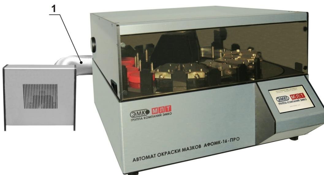
Рис 3. Общий вид АФОМК-16-ПРО с подключенным фильтром.
