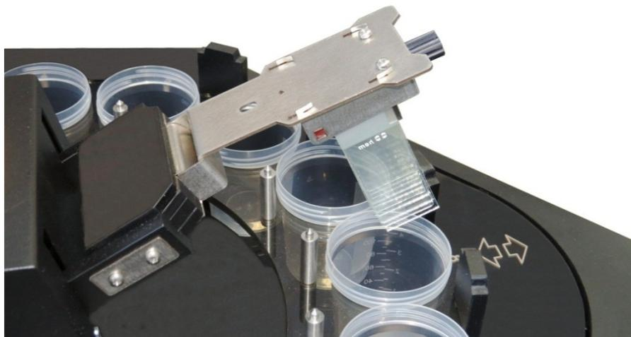
Рис 26. Установка штатива в ловитель манипулятора.
